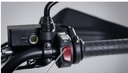
Motor leállító kapcsoló
