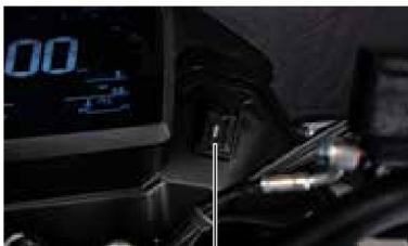
USB-aljzat fedele nyitva
