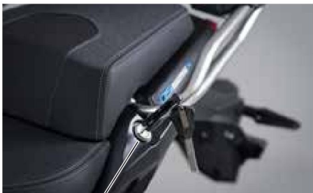
Az utasülés rekeszének kinyitása
