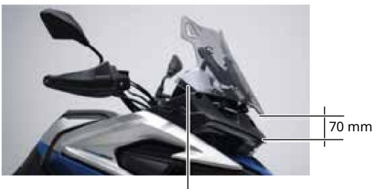
Szélvédő felhúzott helyzete
